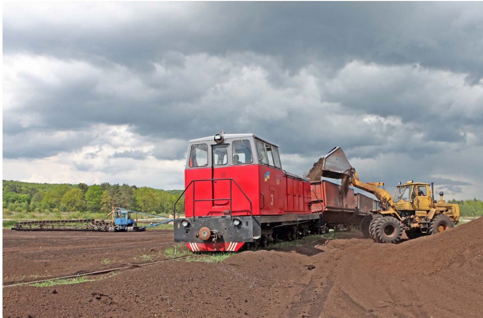
Maidan (Oblast de Rivne, Ukraine) — Tourbière Smiha-Torf — La locomotive TU7A n°3 (TU7-0538 ou TU7-1714) déplace la rame de 8 wagons au fur et à mesure de son chargement. On aperçoit à gauche un engin sur chenilles doté d'une noria articulée permettant le raclage superficiel des banquettes où la tourbe a été pulvérisée en surface, puis sa mise en tas avant reprise par la chargeuse — Photographie Patrick Etiévant —
