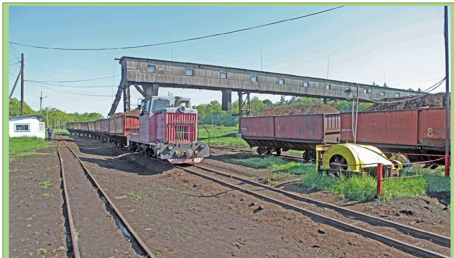
La locomotive KMZ type TU6D n°2 (0033) est vue au poste de recharge des trains en tourbe. Le convoyeur passe au-dessus des voies larges et étroites. On aperçoit à droite un treuil pour le halage des wagons sous les trémies. A gauche, la « gare » - photographie Patrick Etiévant -
