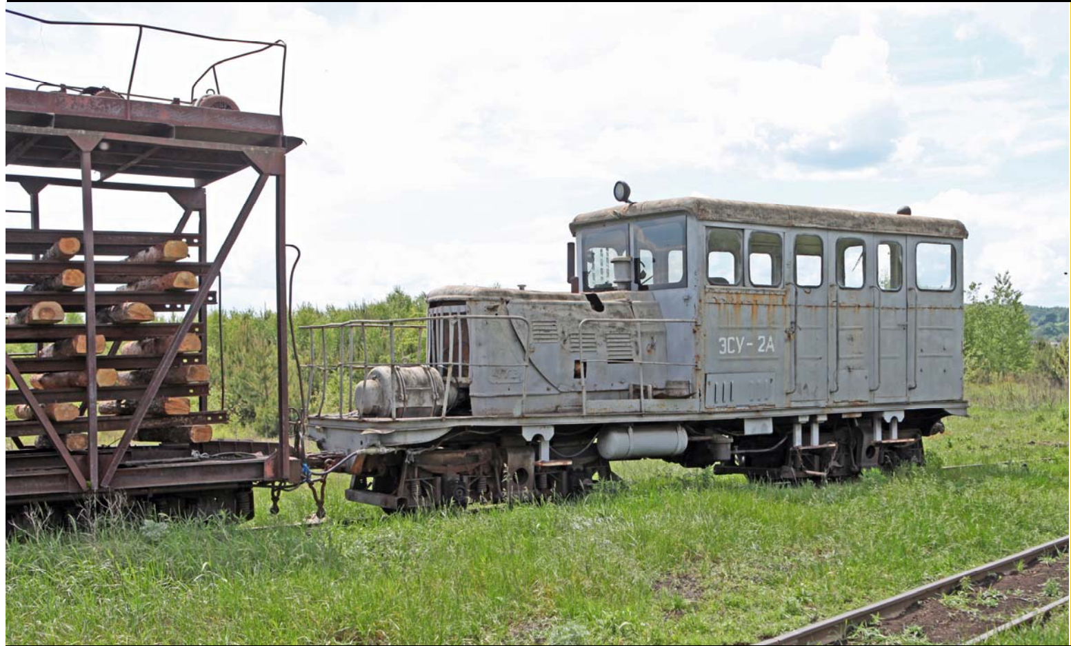
Maidan (Oblast de Rivne, Ukraine) — Tourbière Smiha-Torf — Gros plan sur la locomotive—générateur électrique ESU2A-879 qui assure la traction des trains de travaux et fourni l'énergie électrique au petit matériel. Ce type de locomotive (ЭСУ2А) a été construit de 1972 à 1988 à 1025 exemplaires. L'habitacle permet d'emmener une dizaine de personnes — Photographie Patrick Etiévant —
