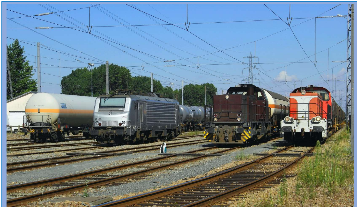
Sur le faisceau fret du Havre, les wagons citernes de produits chimiques constituent un important trafic – photographie Nicolas Poisson – Le matériel de traction VFLI domine : la BB 27168, une BB Vossloh G1206 (la 5001628, unique exemplaire en livrée brun, en location auprès d'Alpha Trains) et une des cinq BB 400 ex 040DE / BB63000 modernisées (voir R&I n°43) en service au Havre.
