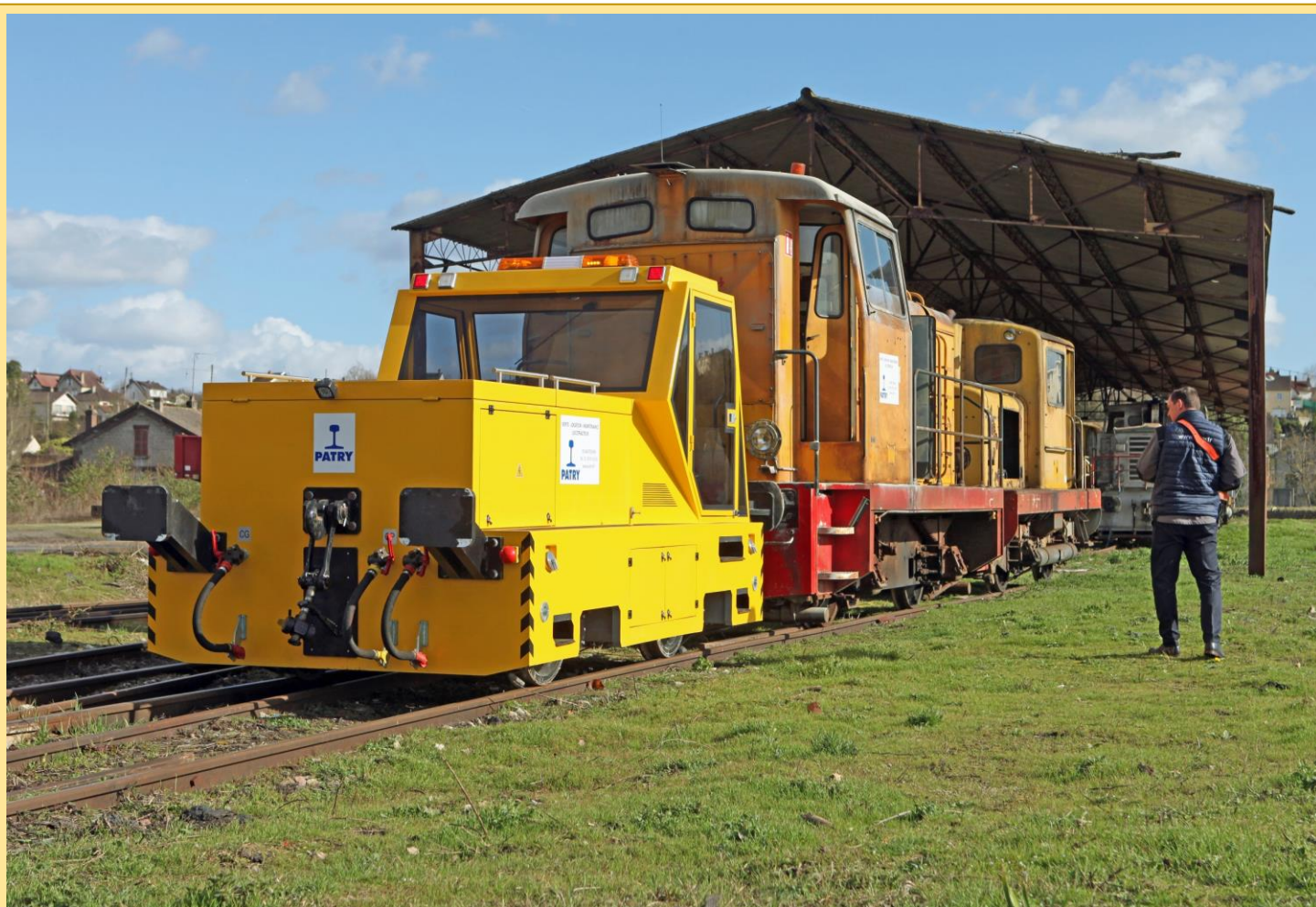
Le locotracteur électrique à batteries ES1000 en évolution chez Patry à Persan, à l'aide de sa radiocommande – Photographie Patrick Etiévant -
