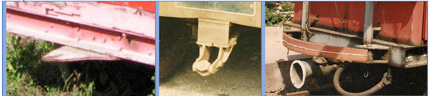
A gauche, plaque munie d'un œil sur les draisines Billard 4.4.15, telle que celle du MTVS. Au centre, manchon pivotant, tel que monté sur les draisines Billard du PO-Midi. Celui-ci est vu ici sur le Dodge rail-route de l'AGRIVAP. Légèrement pivoté verticalement, on aperçoit tout de même sur la face orientée vers le sol, l'embouchure dans laquelle se place la barre, et sur la face du haut, la cheville amovible. A droite, le tampon à lames de ressort elliptiques de la Billard 4.4.29 de l'Historail de St Léonard de Noblat ; en dessous, l'attelage automatique à tulipe, Photos A Dubois
