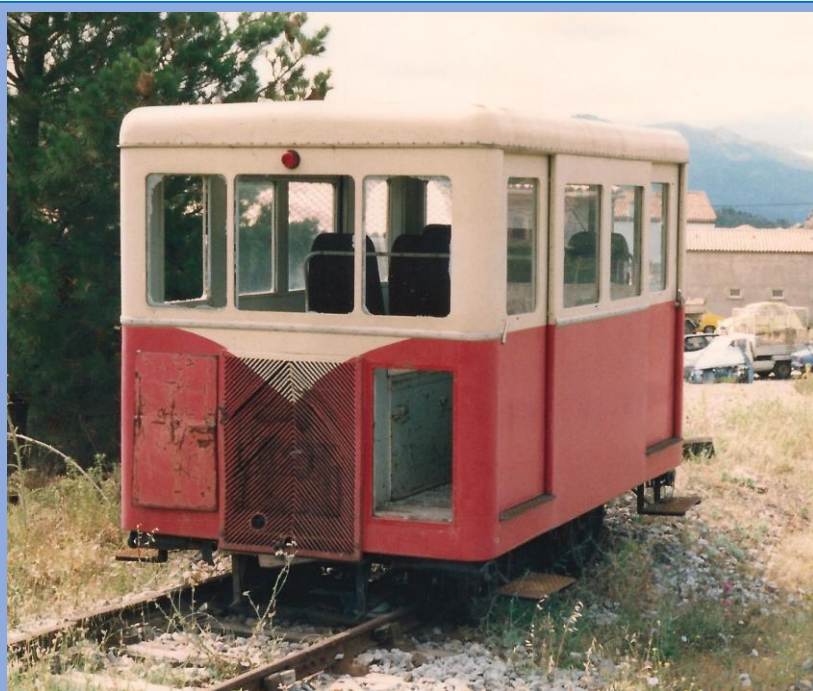
Billard 4-4-15 modernisées sur le réseau Corse, mais de provenance inconnue. Elle a conservé les supports arrière de traverse de pivotement, et les supports latéraux de rampes d'accès. Celles de Franche-Comté, en voie normale, étaient identiques. Photo Bernard BRANSOL, 08-1990, collection AMCL.
