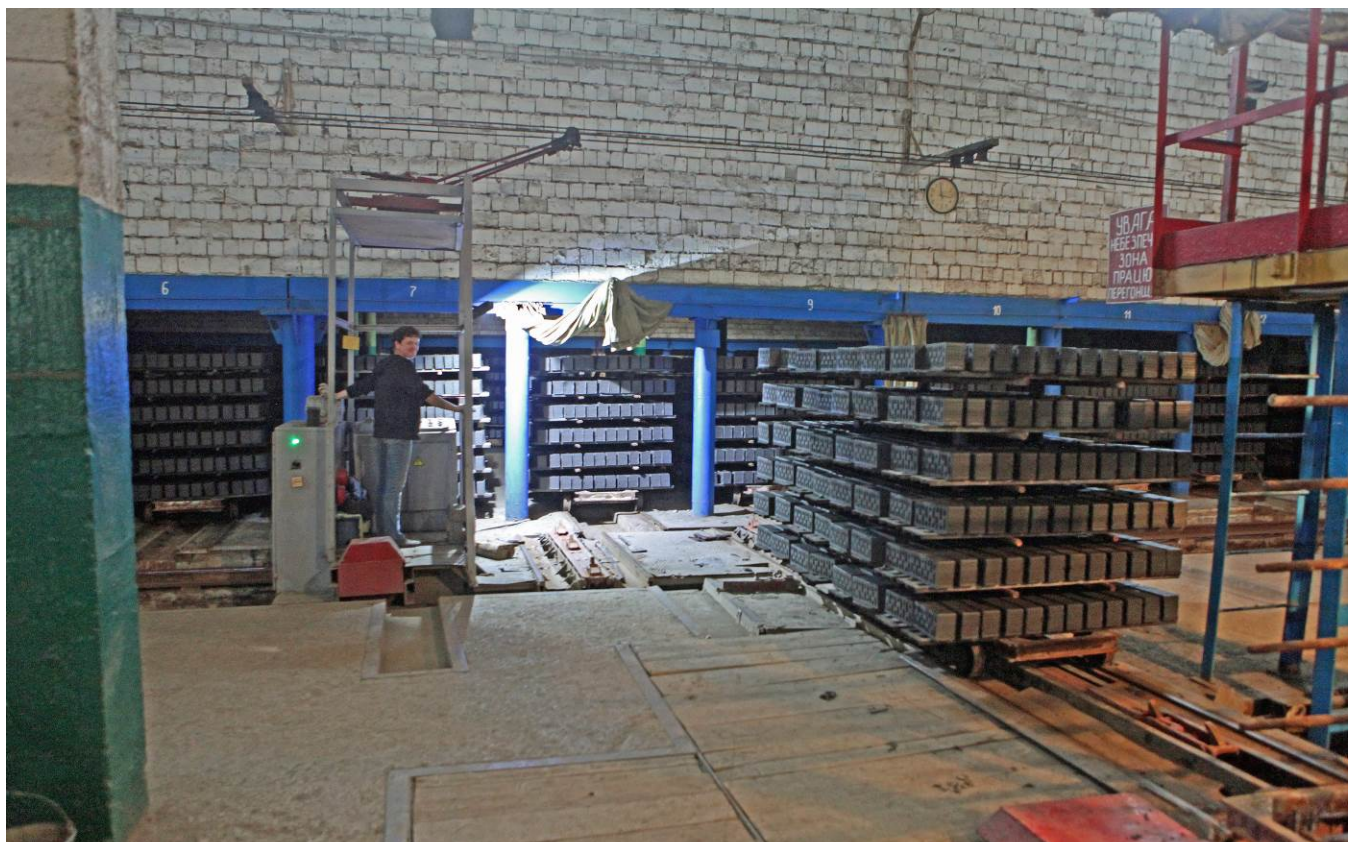
2 chariots chargés d'étagères de briques crues vont être placés sur le chariot transbordeur à 2 voies. Au fond, on aperçoit les voies parallèles qu'il dessert. Celles-ci passent dans l'étuve afin d'accélérer le séchage des briques crues - Photographie Patrick Etiévant -
