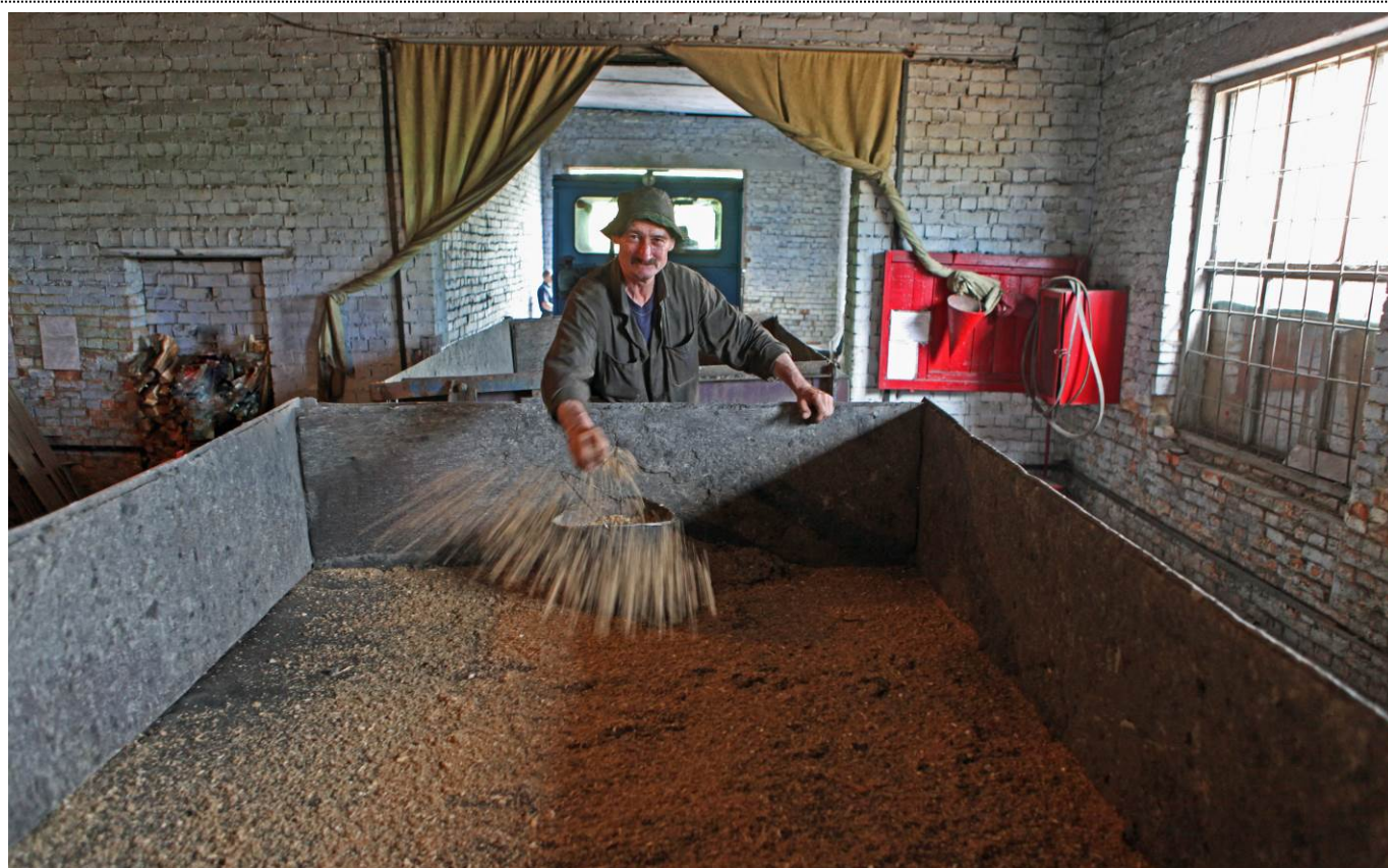
Saupoudrage de sciure dans la benne des wagons pour éviter le colmatage de l'argile qui va y être chargée. Photographie Patrick Etiévant -
