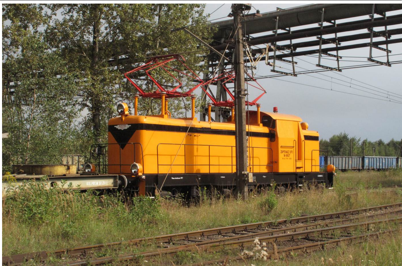
La locomotive diesel électrique SM42 (Fablok n°9273 de 1976 - SM42-2243) a été transformée localement en locomotive électrique télécommandée. Elle est devenue la Zapychacz UFO n°8837 / 700-00124 -photographie Patrick Etiévant -
