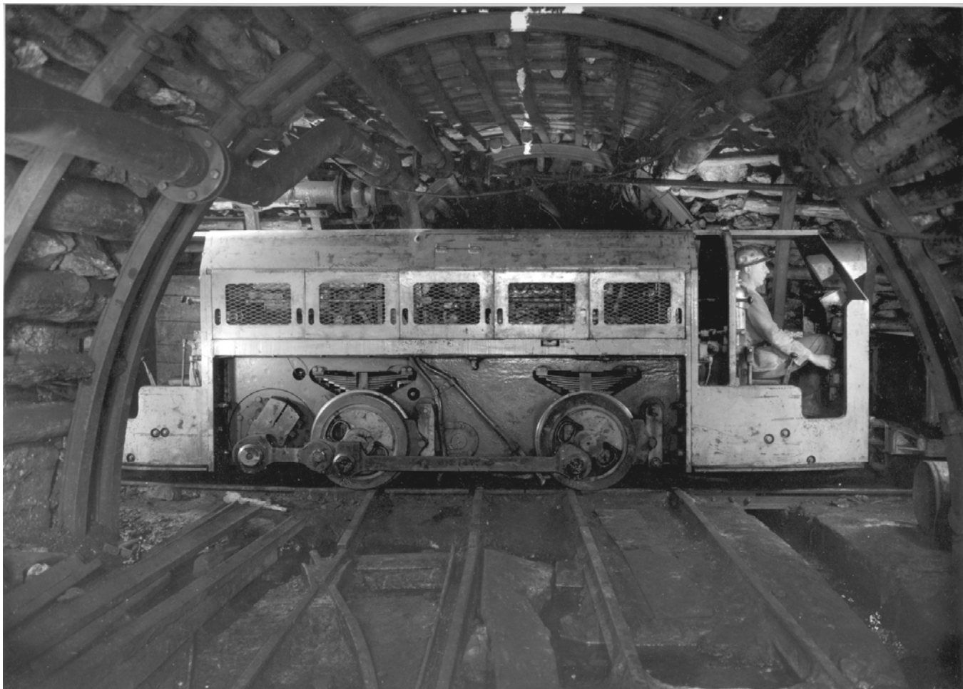
Une locomotive LLD Locomotives et Locotracteurs Diesels du type M16100BED, tarant 15 tonnes et de 100 cv de puissance, vue dans les travaux du fond du groupe Nord. Le caractère exigü des galeries rend la photographie de tels engins au fond de la mine difficile. Le photographe a presque trouvé la position idéale au croisement d'une galerie à double voie... - Collection Philippe Royer -
