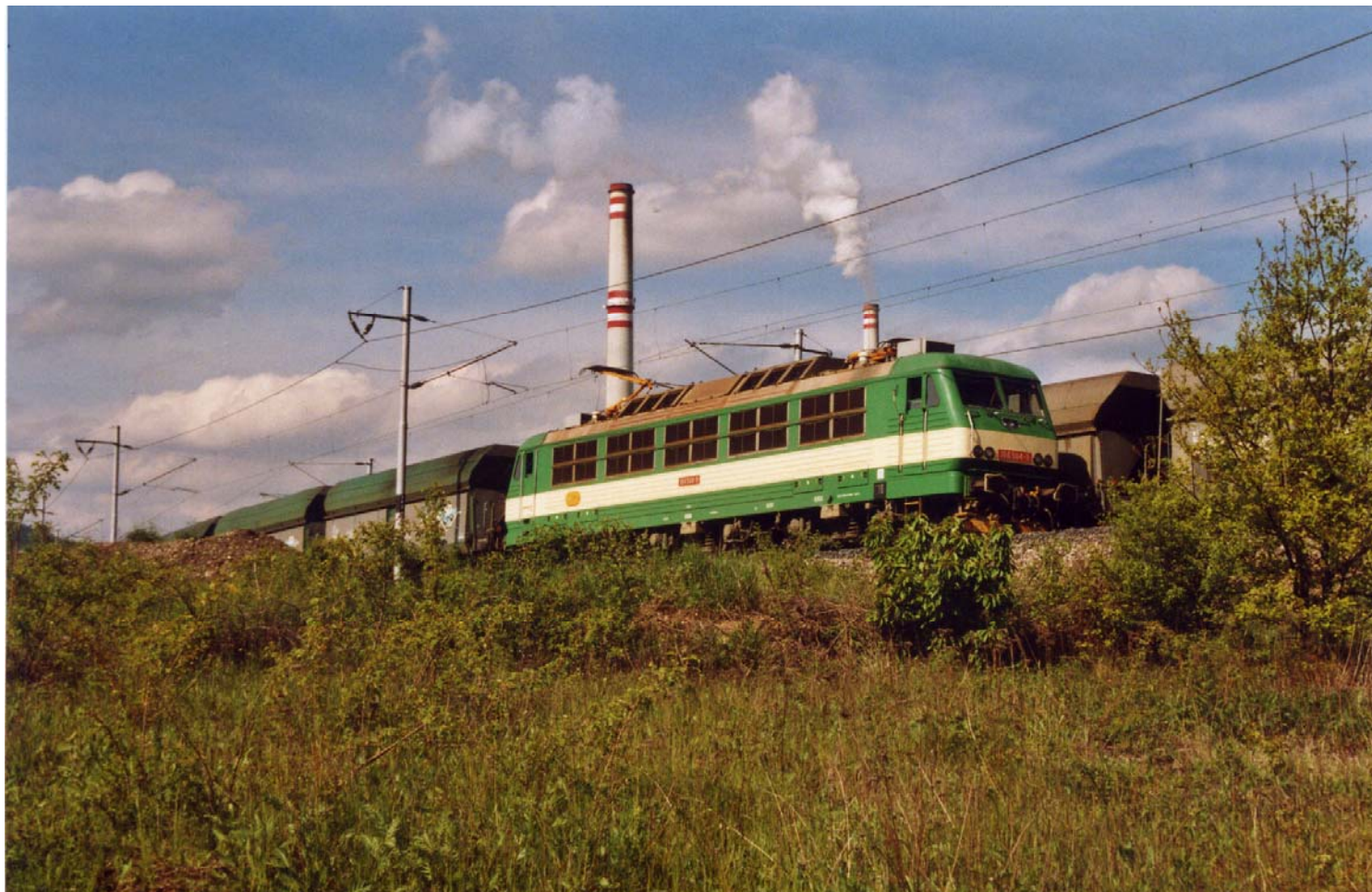
Chomutov (République Tchèque) — S.D Severoceské Doly — la locomotive de configuration BBB n°184.504 — la dernière d'une série de 4 — s'apprête à partir de la centrale thermique de Prunerov à Kadan - le 16 mai 2005 — Cette machine — tarant 120 tonnes — développe une puissance de 5.220 kW, ce qui lui permet de tracter avec aisance des trains de lignite de plus de 2.000 tonnes — photographie Camille Bruneau —
