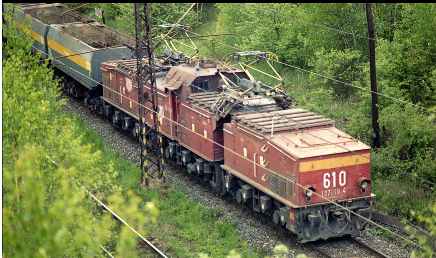
Most (République Tchèque) — M.U.S Mostecka Uhelna Spolecnost — Cette machine de 180 tonnes tractant des wagons pour les terres - n° MUS 610 - a été construite par SKODA en 1973 sous le n° constructeur 6596. Cette locomotive appartient au type 26EM2. La vue plongeante ci-dessus permet de bien distinguer les blocs de résistances électriques disposés à l'extérieur sur les capots des 3 trucks moteurs — photographie Patrick Etiévant —
