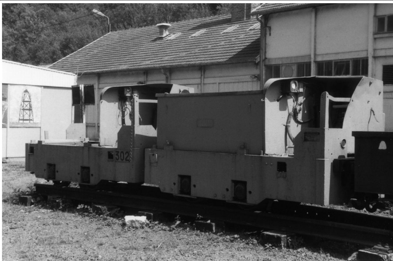
Des locomotives à accumulateurs Milhoud type TJM5 sur le carreau de la Mine de Livet – Photographe Bernard Rozé le 23 juillet 2004.
