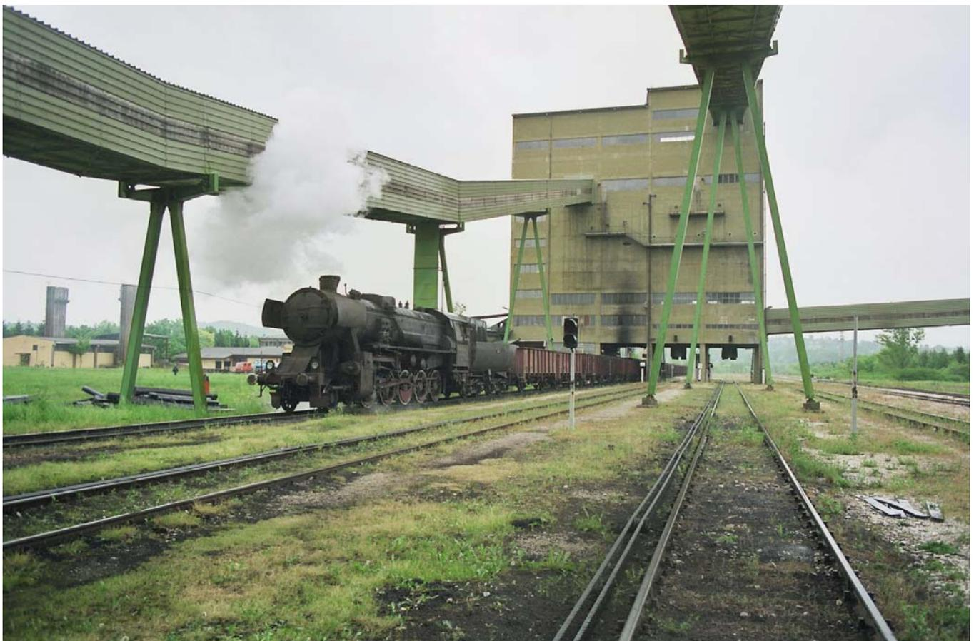
Mine de Sikulje – la 33-236 manœuvre une rame de tombereaux vides à deux essieux – au sol, des câbles assurant le halage latéral des wagons (Photographie Patrick Etiévant)
