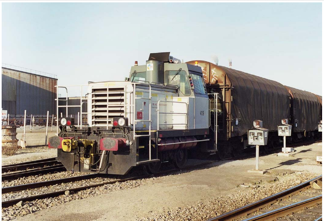
Le nouveau locotracteur CMI type NH300 sur le faisceau des expéditions d'Arcelor à Fos sur Mer. L'engin a reçu un numéro de parc à la suite des locomotives Soviétiques, soit le n°419 - Photographie Patrick Etiévant.
