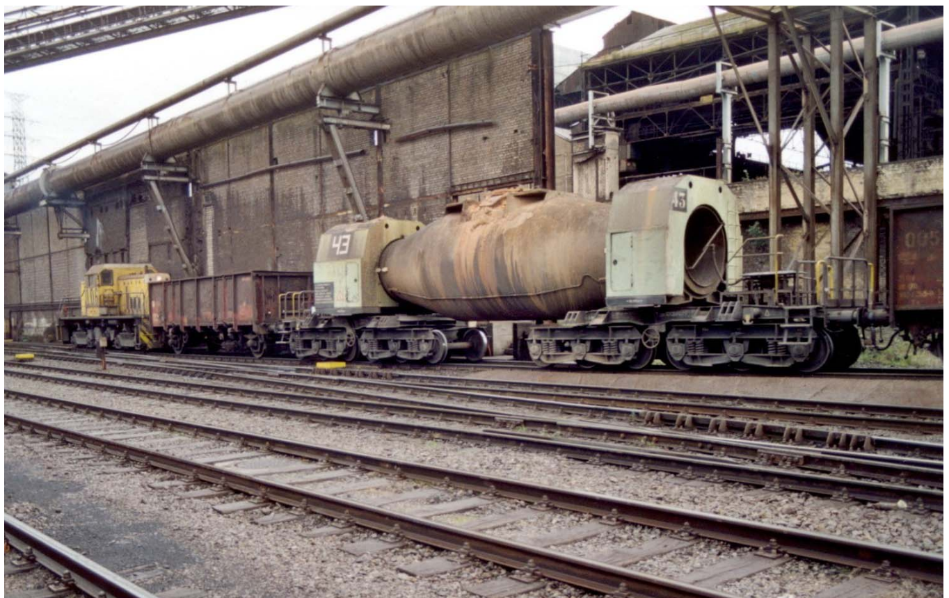
Arcelor – Seraing – La locomotive General Electric n°106 refoule une rame de wagons à poche torpille, dont le « Rolanfer » n°43, en direction du HF 6 – 2003 – Photographie Patrick Etiévant
