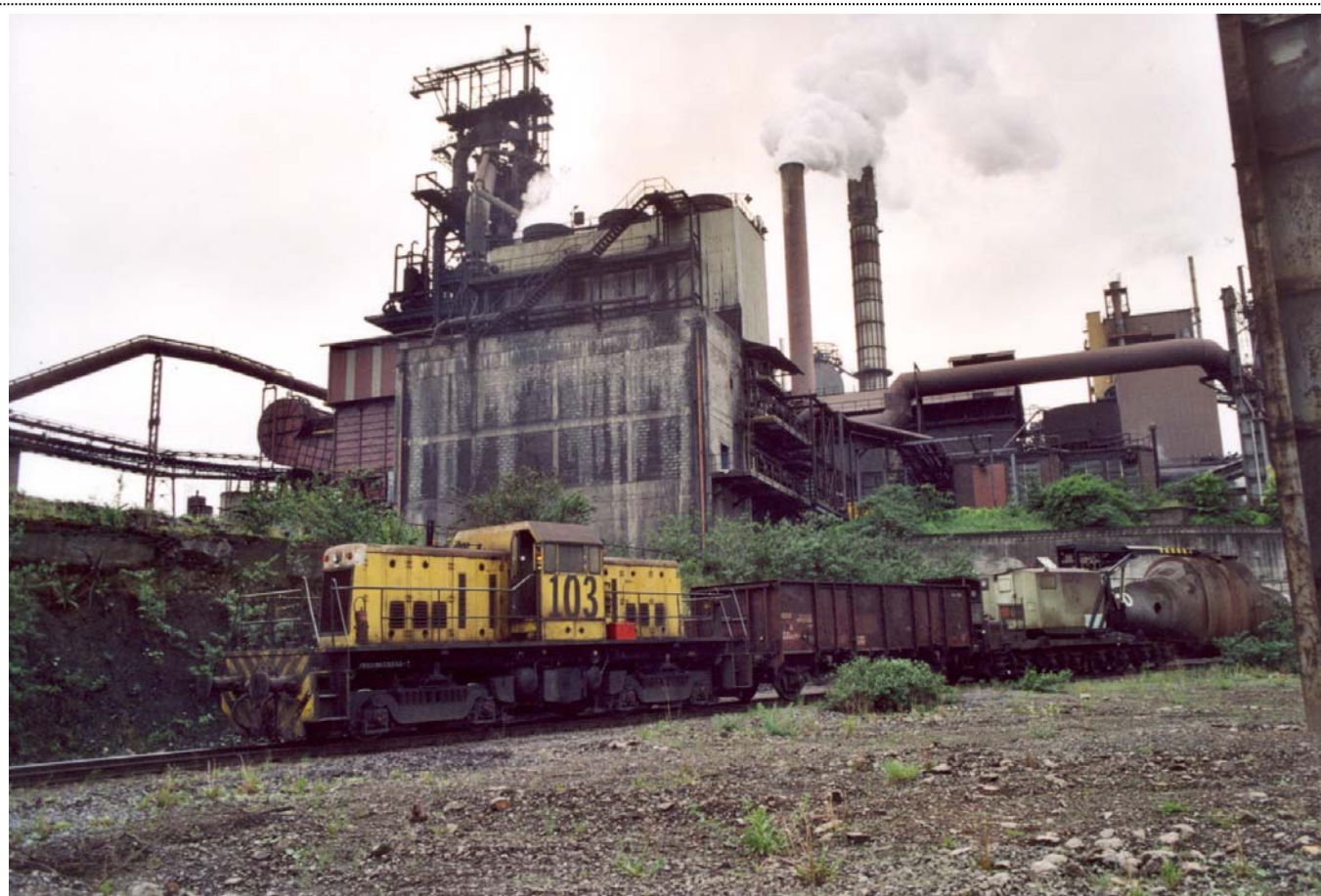
Arcelor : Le Haut Fourneau n°6 à Seraing ex Espérance Longdoz – La locomotive General Electric n°103 retient le wagon à poche torpille Demag Jünkerath n°10 chargé de fonte en fusion - 2003 – photographie Patrick Etiévant
