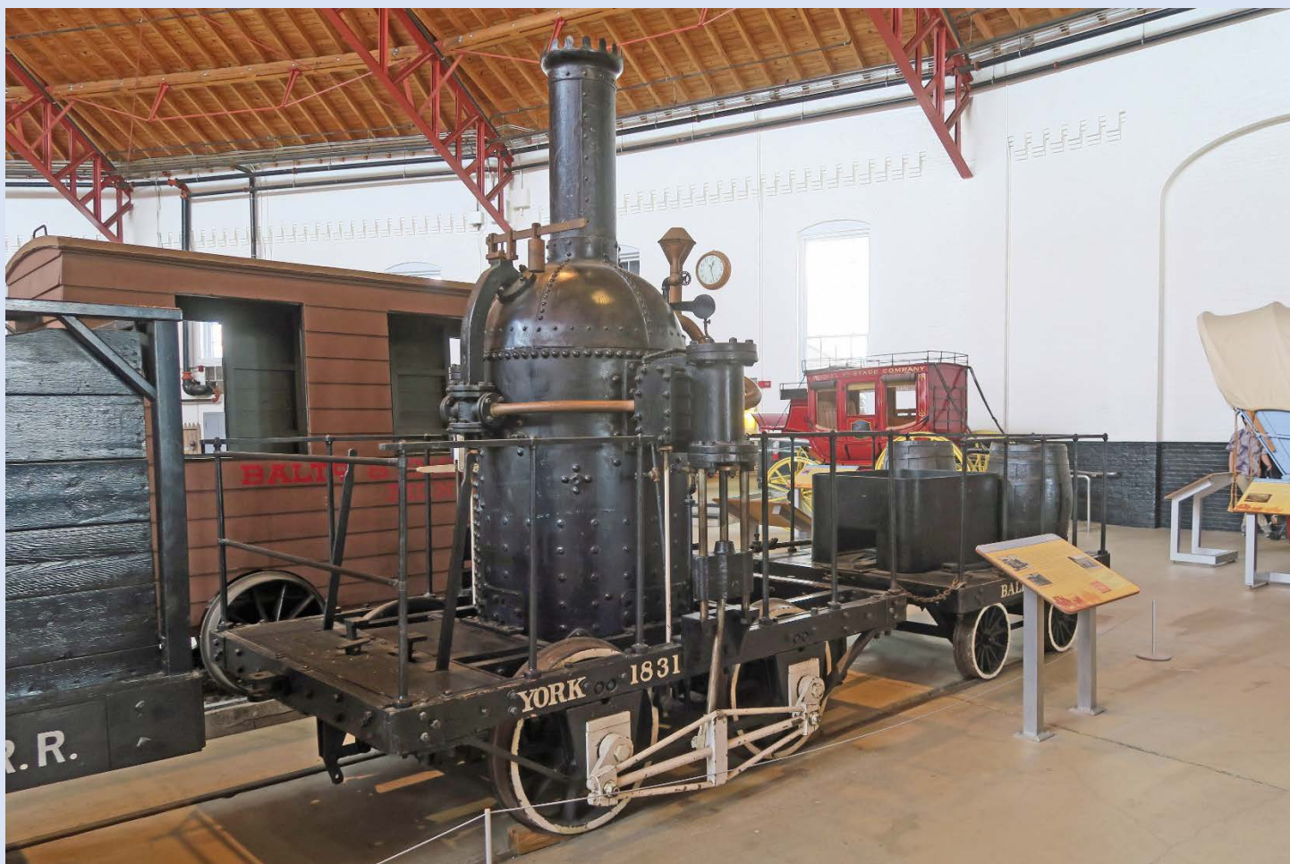
La reproduction (réalisée en 1927) de la locomotive « York » de 1831 à chaudière verticale du Baltimore & Ohio conservée au musée des chemins de fer de Baltimore (USA, Maryland) – photographie Patrick Etiévant –
