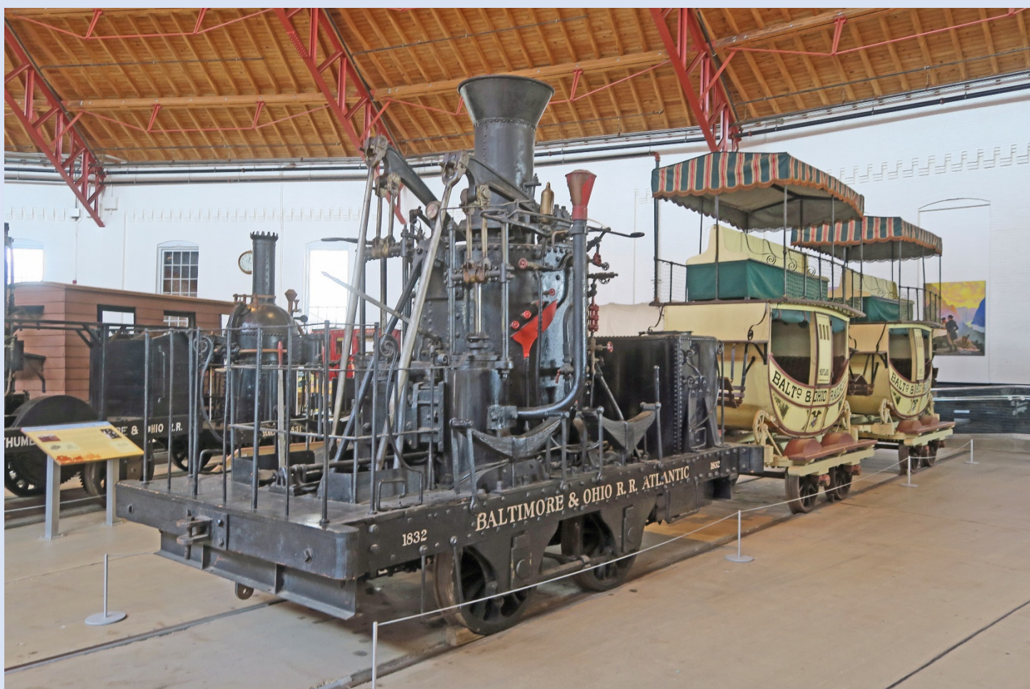
La locomotive de type « Grasshopper » (sauterelle) de 1832 à chaudière verticale du Baltimore & Ohio conservée au musée des chemins de fer de Baltimore (USA, Maryland). Il s'agit en fait de la n°7 « Andrew Jackson » de 1832, employée opérationnellement par le B&O jusqu'en 1892, modifiée en 1927 par le B&O pour « ressembler » à la machine « Atlantic » originelle – photographie Patrick Etiévant –
